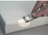
5 傷に充填します。少し盛り上げておいて付属の透明フィルムをかぶせ、ヘラなどで平らになるよう延ばしフィルムが動かないようテープなどで固定します
