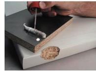
2 ミキシングボードなどに主剤：硬化剤 = 50 : 1 ([図2] 6 cmに対し1センチ程度) を出します。2液性のパテは化学反応で硬化しますので寒い時など熱を奪いますので硬化が遅くなります。硬化剤を少し多めにするかドライヤーなどで熱を加えると早く硬化します
