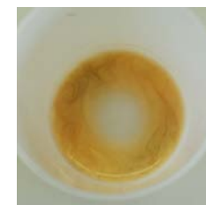
セルローズシンナーで 顔料を溶きます
